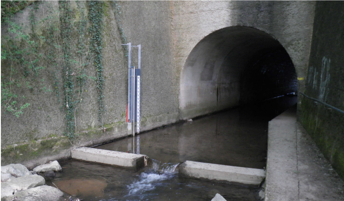
FIGURE 37 – Photo de la section de contrôle de la station hydrométrique du Ratier
