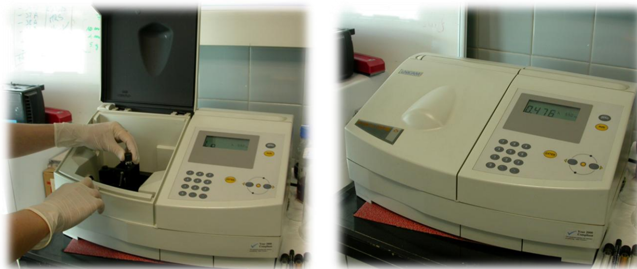
Figure 1 - Mise en place de l'échantillon dans le spectrophotomètre et lecture de la densité optique
