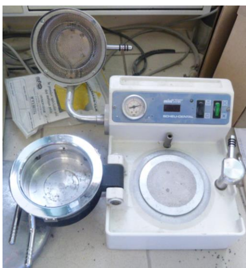
Figure 15 : Machine à thermoformer par pression positive MINISTAR® (SCHEU-DENTAL, Iserlohn Germany). Photo de l'auteur
