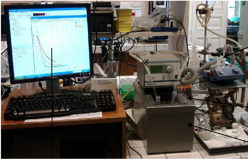
Sonde à Oxygène et cuve réactionnelle
