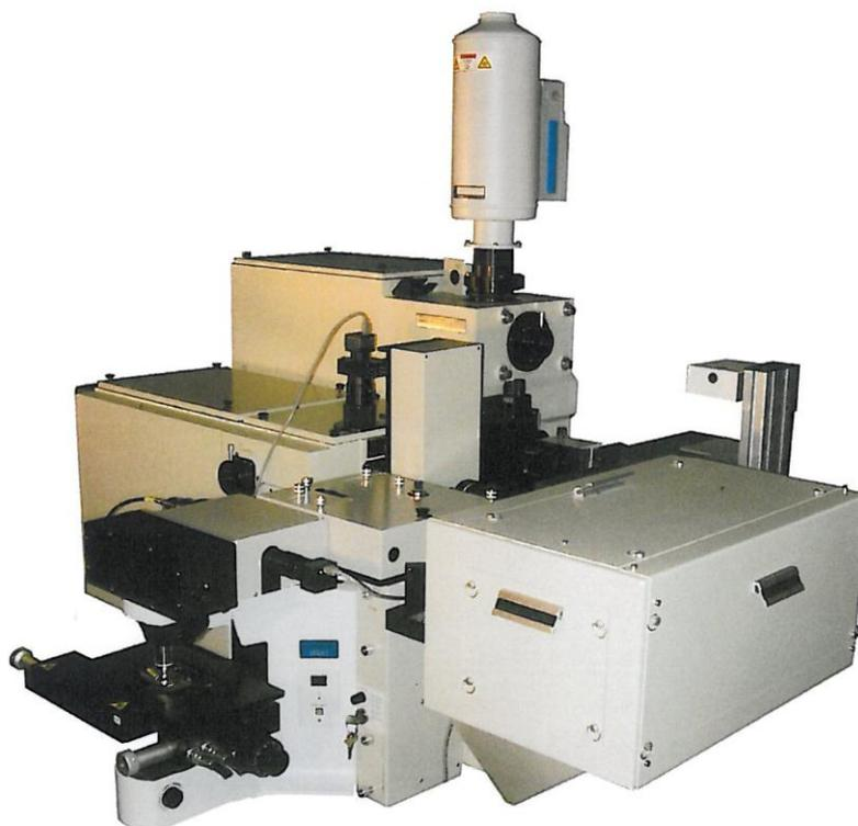
Le spectromètre RAMAN utilisé est le modèle T64000 de chez HORIBA JOBYN-YVON.
