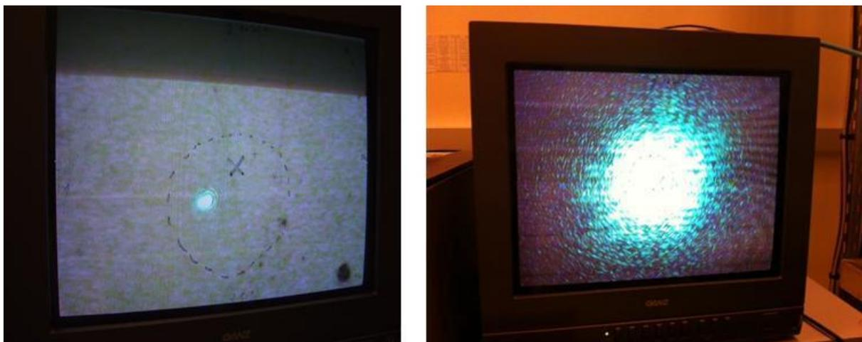
*Figure 37 : Ecran de visualisation du spot laser issu de la fibre aller sur l'échantillon. A gauche, visualisation du spot laser sur la surface de l'échantillon dans le cas d'un mauvais réglage de fibre optique retour, à droite, le cas d'un bon réglage de fibre*
