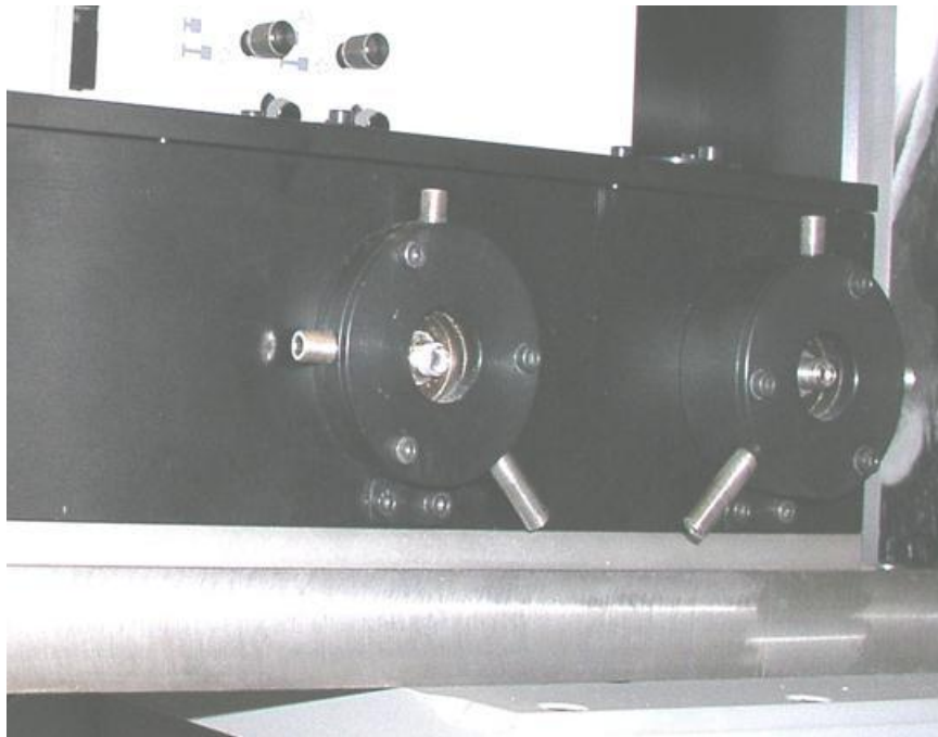
Figure 34 : Photographie des deux anciens positionneurs de fibre (à gauche, celui de la fibre optique aller, à droite celui de la fibre optique retour) situés sur la paroi latérale du microscope BX50 en cellule.
