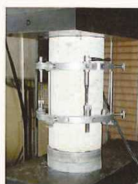
Essai de compression simple
