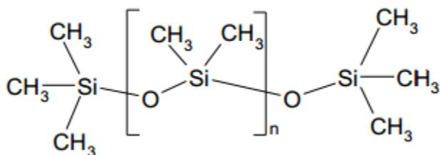
**Figure 7 : Formule chimique développée du diméthicone [33]**
