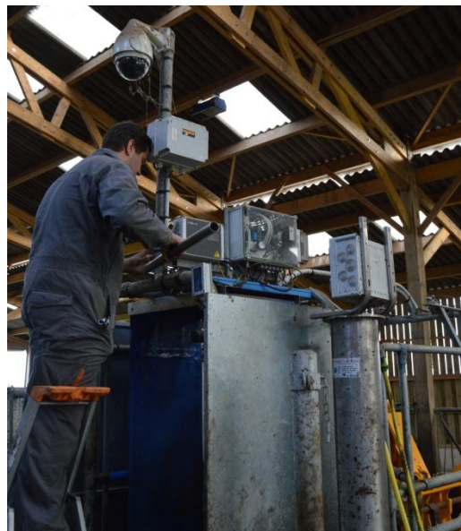
Figure 1 – Déconnexion de la porte de tri et débranchement de la caméra.
