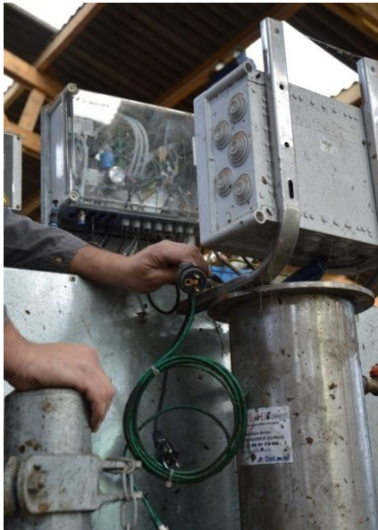
Figure 1 – Déconnexion de la porte de tri et débranchement de la caméra.
