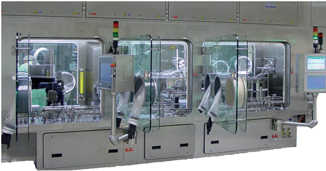
Figure 12 Photo d'un isolateur de répartition aseptique portes ouvertes (SKAN AG)
