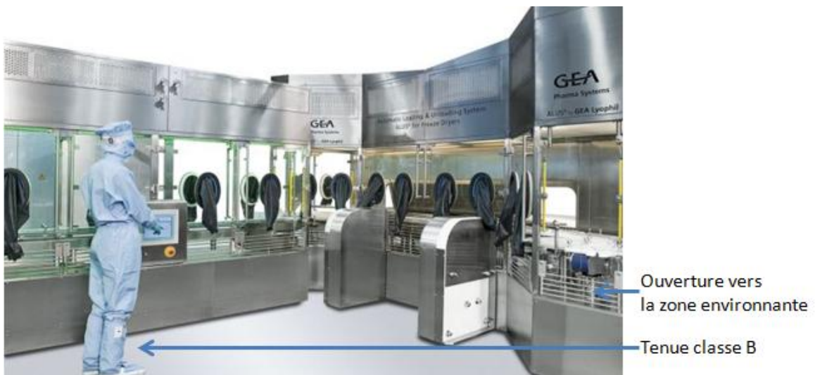
Figure 19 Schéma et photo d'un RABS "actif" (Rauschnabel J. 2007 ; Franz Ziel GmbH 2014)
