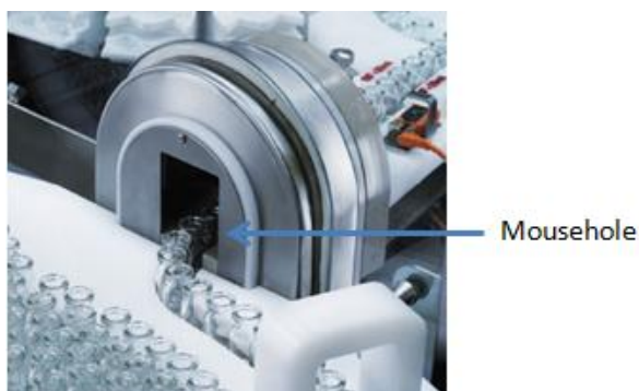
Figure 13 Photo d'un mousehole permettant l'entrée des flacons (Rauschnabel J. 2007)
