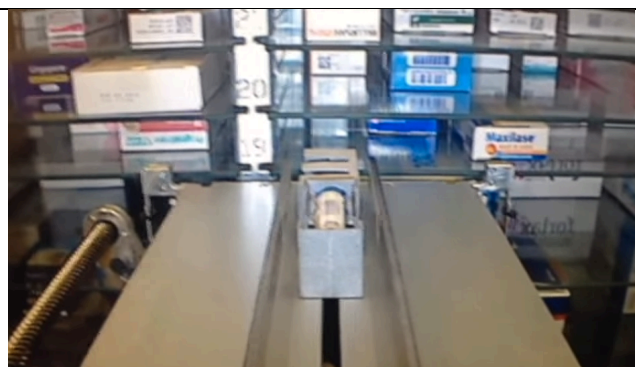
Figure 19: Acheminement de tubes homéopathiques dans un « ROWA » d'ARX®
