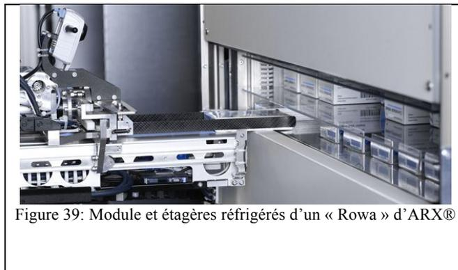
Figure 39: Module et étagères réfrigérés d'un « Rowa » d'ARX®
