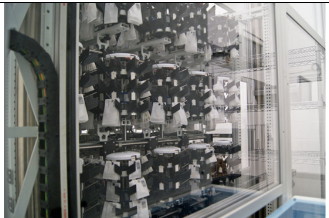
Figure 66: Sachets de médicaments pour un individu disposés sur des anneaux dans le dispositif de stockage du « Pillpick »
