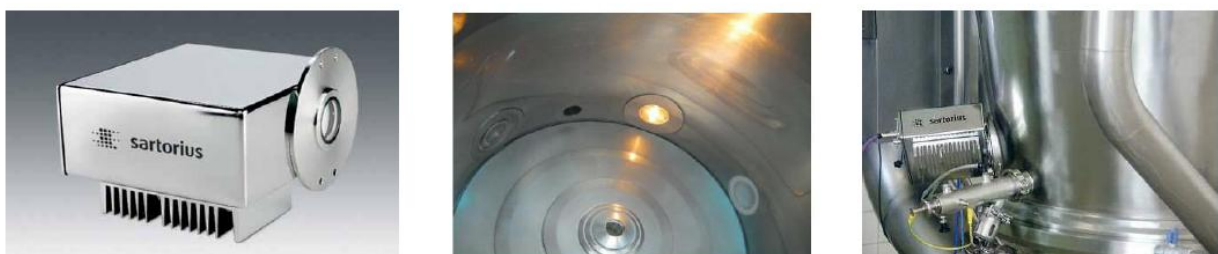
Figure 31: Spectrophotomètre Sartorius (gauche), bride saphir intégrée au sécheur (milieu) et capteur fixé sur l'extérieur (droite)
