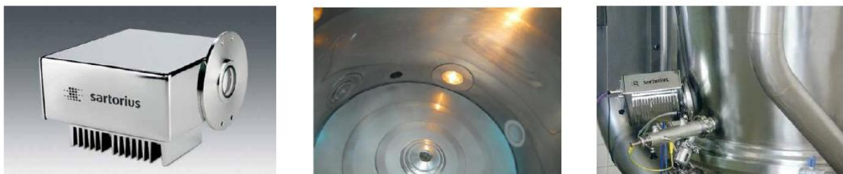
Figure 31: Spectrophotomètre Sartorius (gauche), bride saphir intégrée au sécheur (milieu) et capteur fixé sur l'extérieur (droite)
