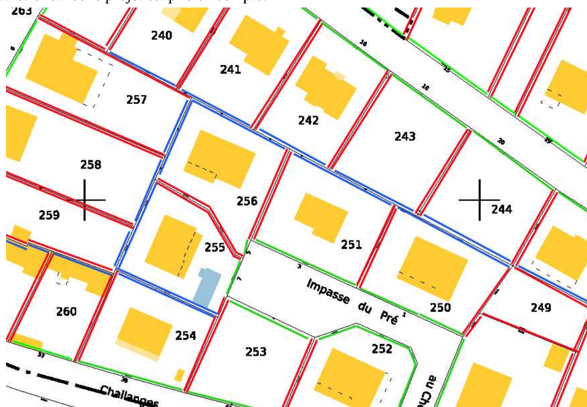
Figure 9 – Représentation des limites latérales (en rouge), des limites de fond (en bleu) et de l'alignement (en vert) d'après l'extrait cadastral d'un quartier de Beaune
