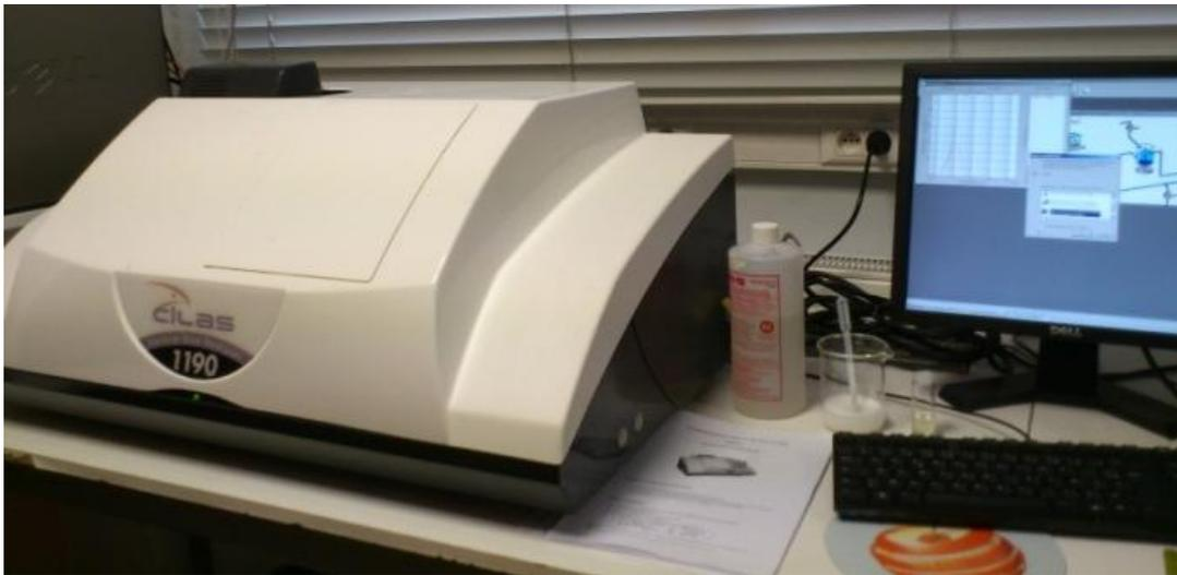
**Figure 14** : Granulomètre Cilas
