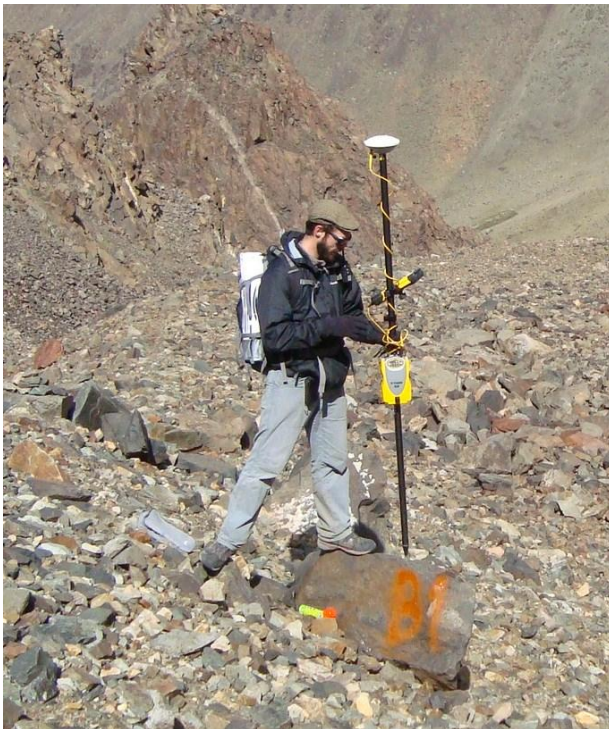
Figure 12: Mesures DGPS sur un glacier rocheux dans le Cordon del Plata, Mendoza, Argentine
