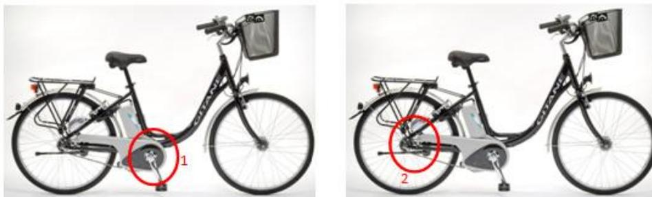
**Figure 12** : Schéma des possibles emplacements du moteur
