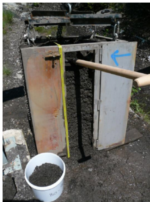
Figure 15: Photographie de la méthode d'extraction par couches de 10 cm
