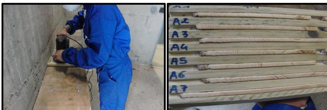
Figure 16: ponçage sous ponceuse rotative sous trois tailles de grains : 120, 320, 600 (source : Labessoulhe, 2014).
