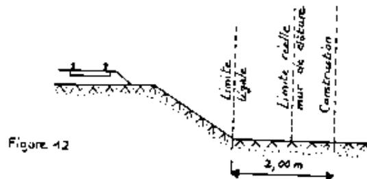
Il résulte des dispositions précédentes que si les clôtures sont autorisées à la limite réelle du chemin de fer, les constructions doivent être établies en retrait de cette limite réelle dans le cas où celle-ci est située à moins de deux mètres de la limite légale.
