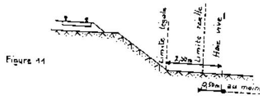
Dans tous les cas, l'implantation des règles ci-dessus ne doit pas conduire à planter un arbre à moins de deux mètres de la limite réelle du chemin de fer et une haie vive à moins de 0,50 mètre de cette limite.
