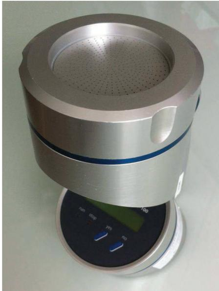
**Figure 3 :** Biocollecteur utilisé pour les prélèvements microbiologiques d'air
