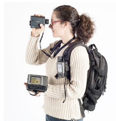
Document 8 : Ordinateur de terrain couplé avec un laser télémètre
