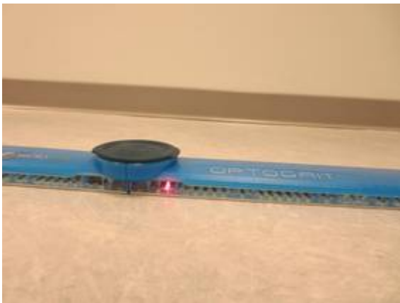
Figure n°5. Leds du couloir de marche Optogait
