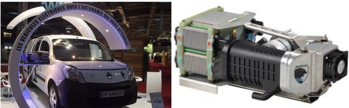
*Figure 7 - Renault Kangoo Electrique ZE et la pile à combustible conçue par Symbio Fcell (Renault – 2012)*
