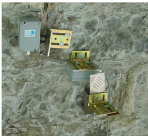
Fig. I.38 – Couplage de fissuromètres pour un suivi tri-dimensionnel
