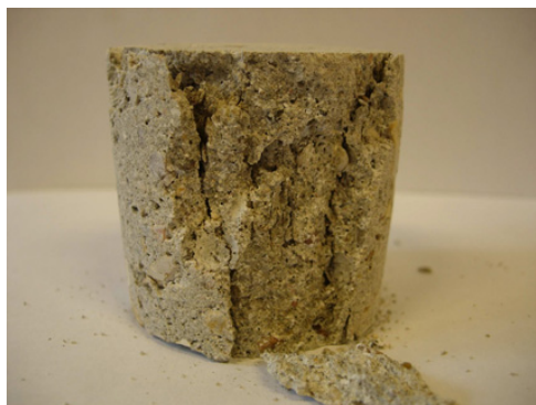
Fig. I.52 – Éprouvette de mortier pour test en compression après rupture, [Sta11]
