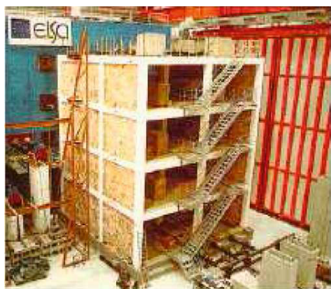
Fig. II.4 – Exemple de structure testée sur un mur de réaction (ELSA, Ispra) [Sol07]
