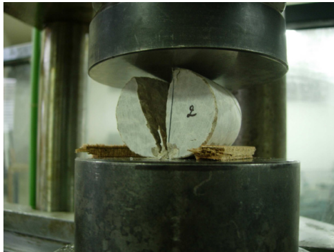
Fig. I.53 – Éprouvette de test de fendage sous presse, [Sta11]
