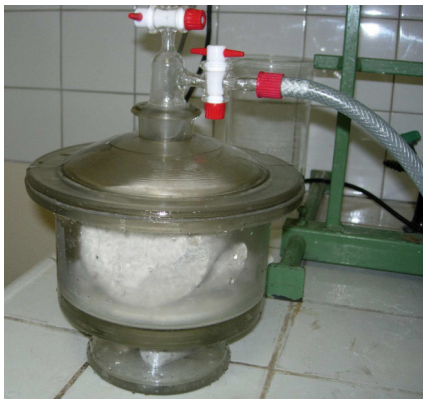
Fig. I.50 – Enceinte de saturation en eau pour les mesures de porosité et de masse volumique [Sta11]
