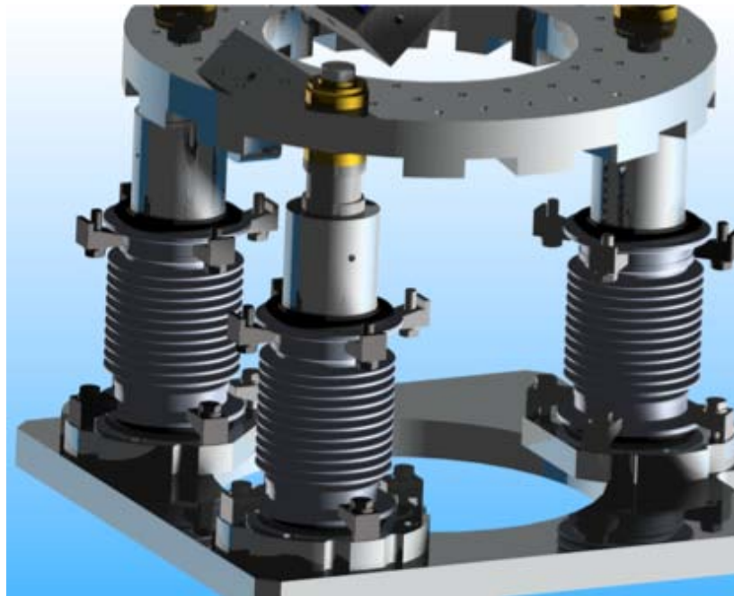
Figure 52 : Détail des pieds avec le système d'ajustement (jaune), le plateau et les soufflets.
