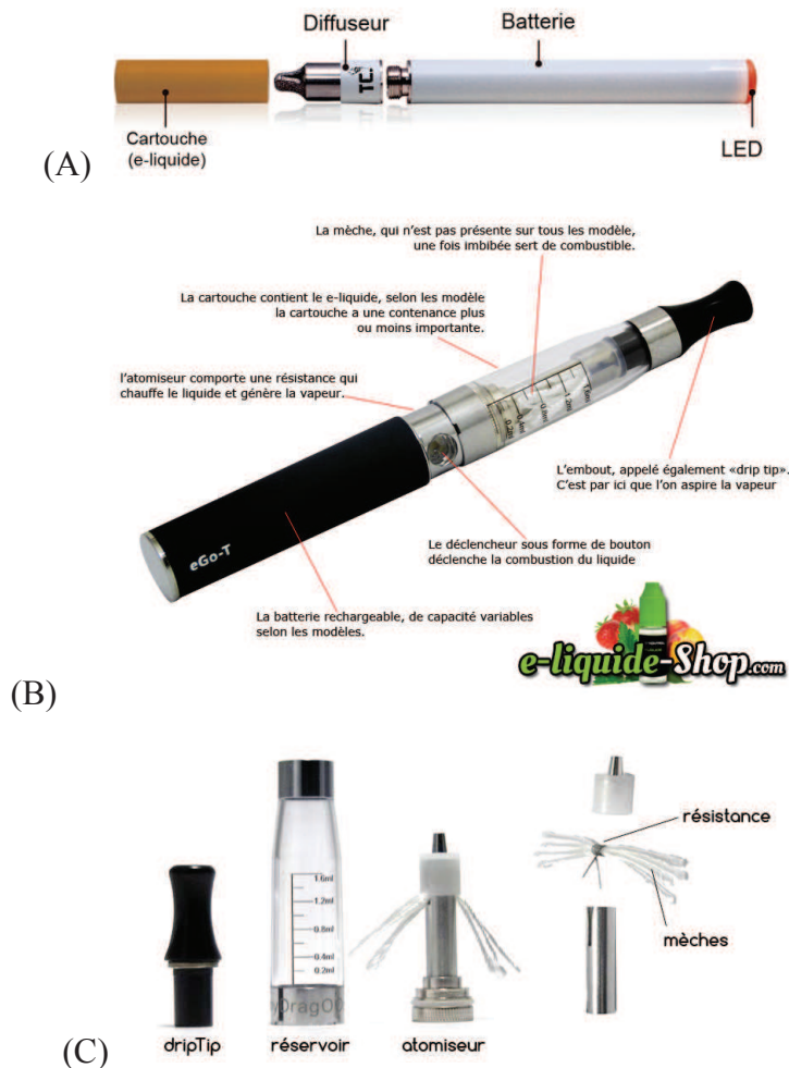
Figure 4 – (A) Cigarette électronique de première génération (B) Cigarette électronique de seconde génération (C) Structure d'un clearomiseur
