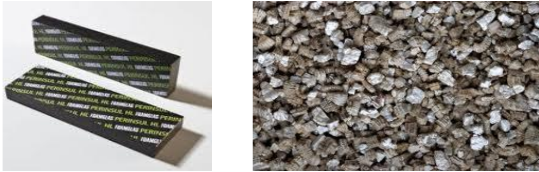
Figure 12: Quelques exemples d'isolants minéraux, verre cellulaire et vermiculite (Foamglass et Fermacell).
