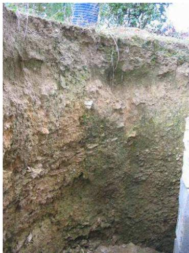
**Figure 73 : Reconstitution d'une coupe de sol (terre végétale, colluvion et argiles)**
