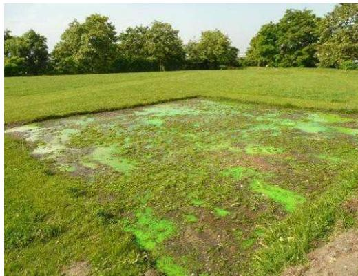
**Figure 45 : Infiltration du colorant sur le site des Provençaux (PZ3)**
