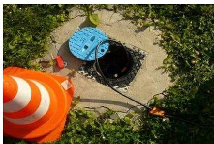
**Figure 40 : Photo de relevé des mesures piézométriques**
