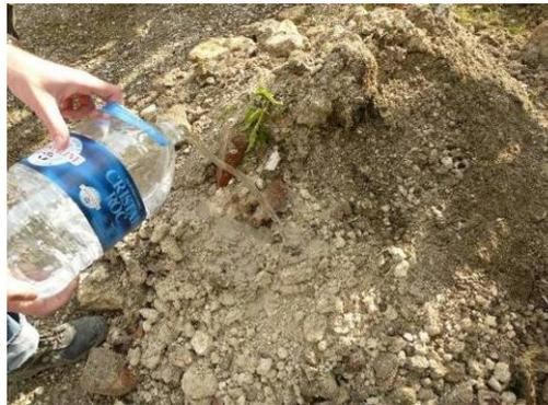
**Figure 47 : Utilisation d'eau pour révéler le colorant dans le sol**
