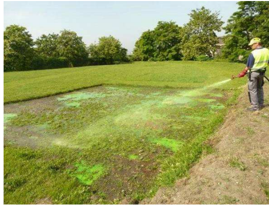
Figure 46 : Mise en œuvre du mélange eau + colorant
