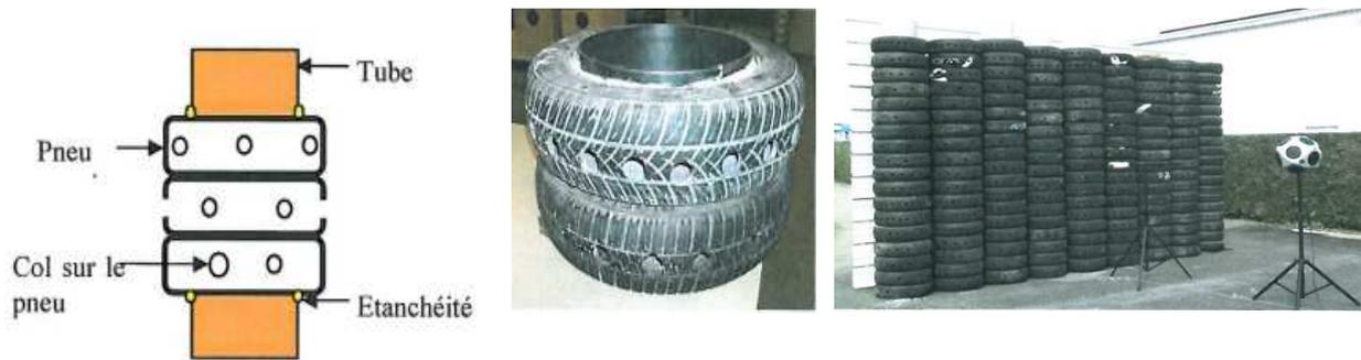
a) Principe de montage des pneus
