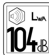
Figure 6 : Etiquetage de la puissance acoustique sur les engins de chantier.
