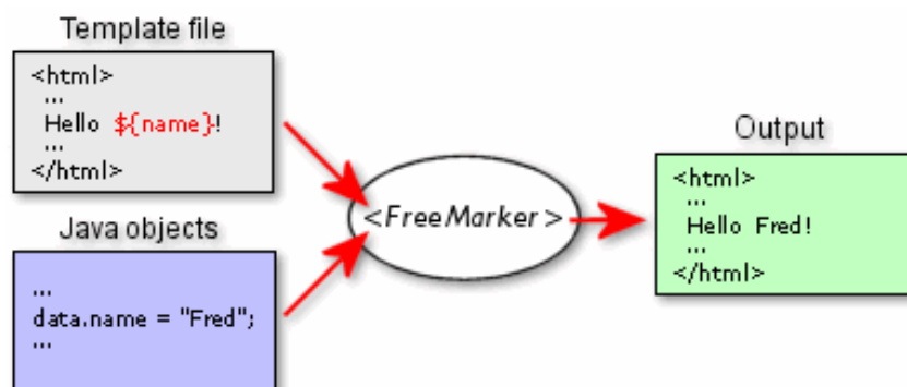
Figure 6.10, Principe de l'API FreeMarker , freemarker.sourceforge.net .
