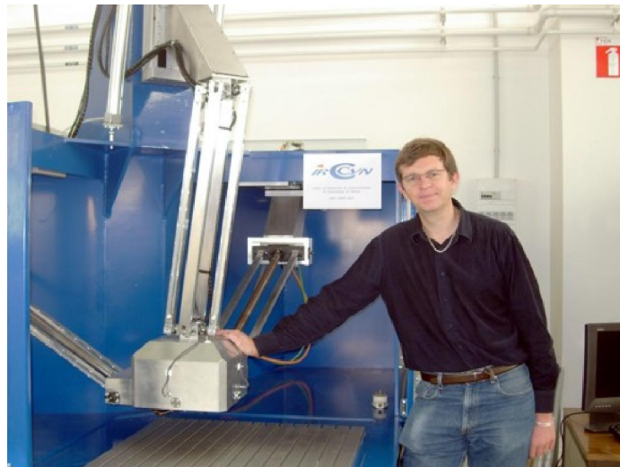
Figure 7.1 : Orthoglide industrielle (et son concepteur)
