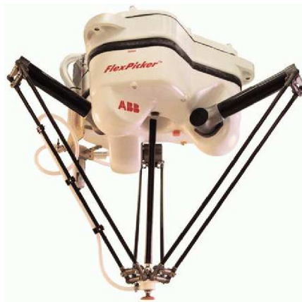
Figure 2.2 : Familles des robots delta
