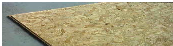
Photo 2.2.5.1.9a : Exemple type panneau OSB
