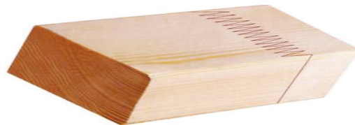
Figure 2.2.5.1.8: Exemple de bois massif abouté ne comprend que très peu de colle : joint d'aboutage tous les 2 à 3m
