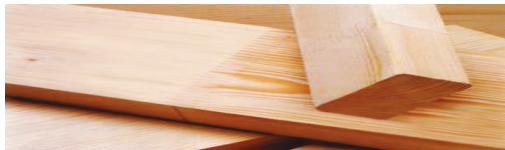
Figure 2.2.5.1.8: Exemple de bois massif abouté ne comprend que très peu de colle : joint d'aboutage tous les 2 à 3m
