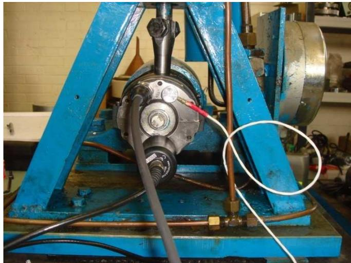
*Figure 51 : Position des capteurs sur le bloc roulement*
