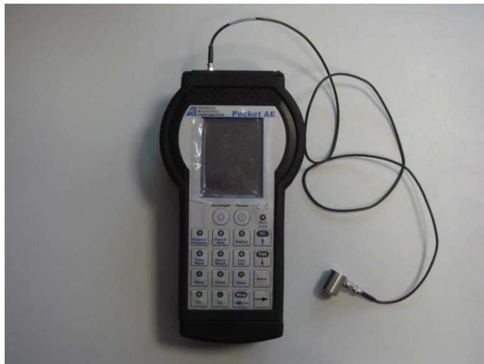
*Figure 27 : Système d'acquisition en Emission Acoustique (Pocket AE)*
