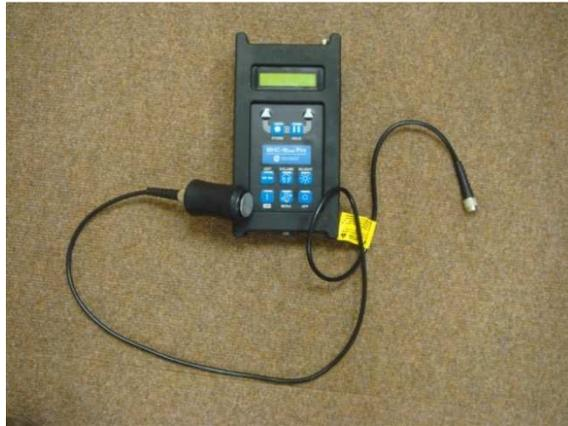
*Figure 61 : Système d'acquisition Holroyd*
