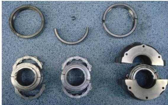
Figure 57 : Eclaté d'un roulement COOPER SPLIT 01C/40GR
