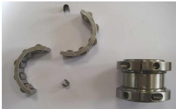
Figure 58 : Défaut artificiel réalisé sur la bague interne
