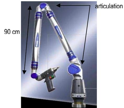
Figure 18 : Bras de mesure dimensionnelle Faro type Platinum, [www.faro.com](http://www.faro.com) (2012)
