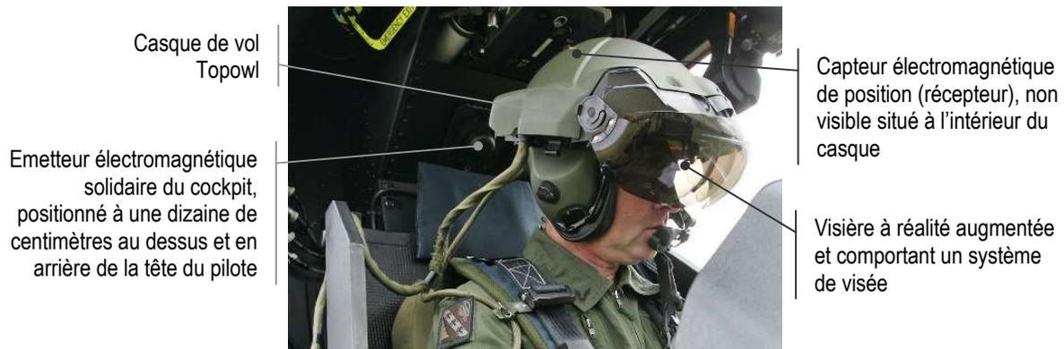
Figure 13 : Traqueur électromagnétique de position à bord de l'hélicoptère Tigre (Photo. Extrait du site [www.aviation-francaise.com](http://www.aviation-francaise.com), Topowl.jpg, 2013)
