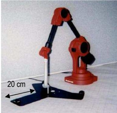
Figure 17 : Bras de mesure de précision d'après Foxlin *et al.* [12]
