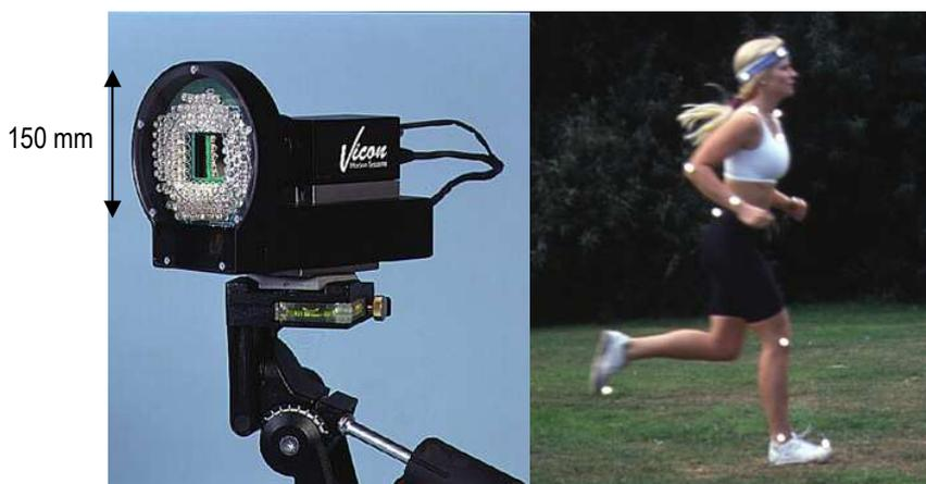
Figure 38 : Système Vicon avec caméra muni de LED infrarouges et marqueurs auto-réfléchissants, [www.vicon.com](http://www.vicon.com) (2007)
