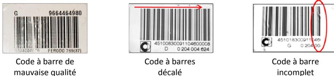
Figure 37 – Défauts d'impression des codes à barres
