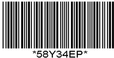
Figure 48 – Symbole de code à barres en code 39
