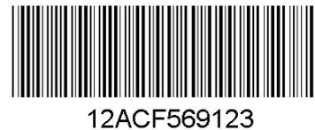
Figure 45 – Code à barres en code 39
