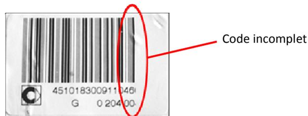
Figure 91 – Etiquette SMART avec un code à barres incomplet
