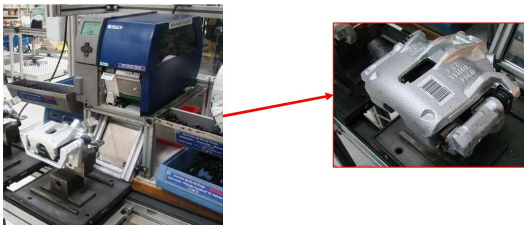
Figure 24 – Poste d'impression / Vue d'un frein avec étiquette code à barres
