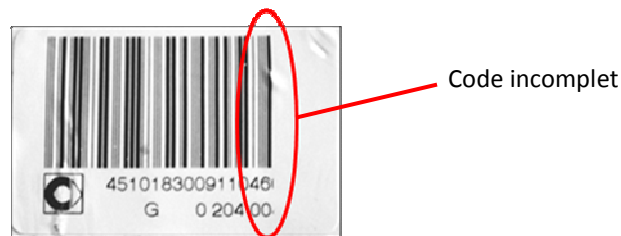
Figure 91 – Etiquette SMART avec un code à barres incomplet
