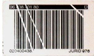
Figure 78 – Défaut d'impression dû à un pli du film transfert
