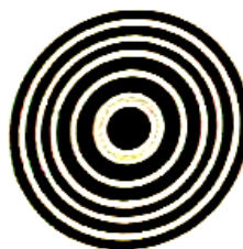
Figure 43 – Code à barres "Œil de bœuf" développé par B. SILVER et N.J. WOODLAND
