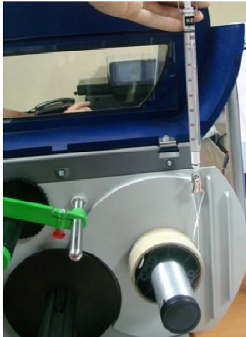
Figure 72 – Mesure de l'effort de traction sur l'axe dérouleur du rouleau d'étiquettes
