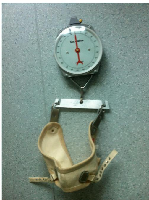
Figure 15 : Collier de Sayre fixé à un dynamomètre
