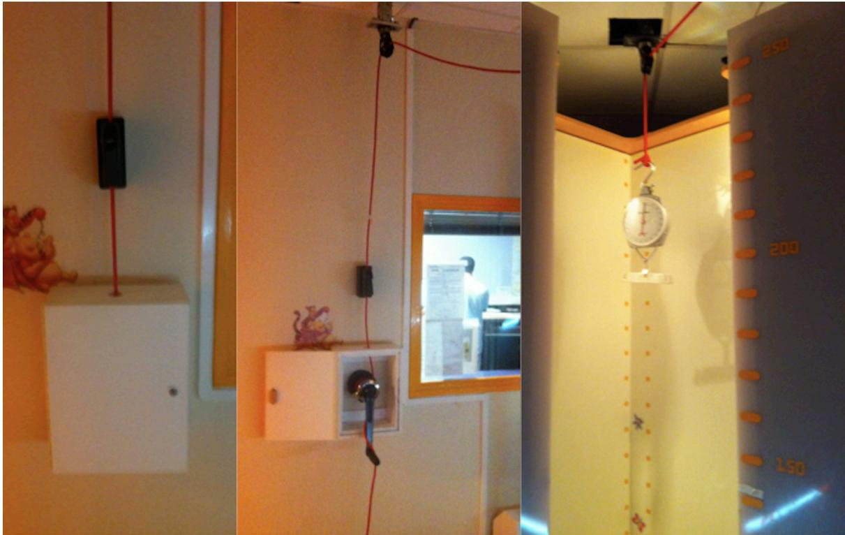
Figure 13 : Système de suspension mis en place dans la cabine EOS composé d'une corde de traction passant dans deux poulies fixées au plafond et rattachée à un winch.
