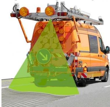
Figure 2 : Système de scan 3D mobile de la chaussée (source : gizmag.com)
