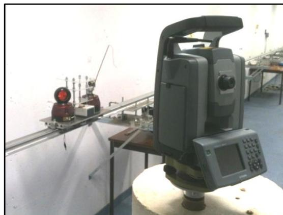
Figure 10 : Photographie du dispositif mis en place pour le protocole d'auscultation, avec le chariot équipé d'un prisme (à gauche) et le tachéomètre S8 de Trimble© (à droite).
