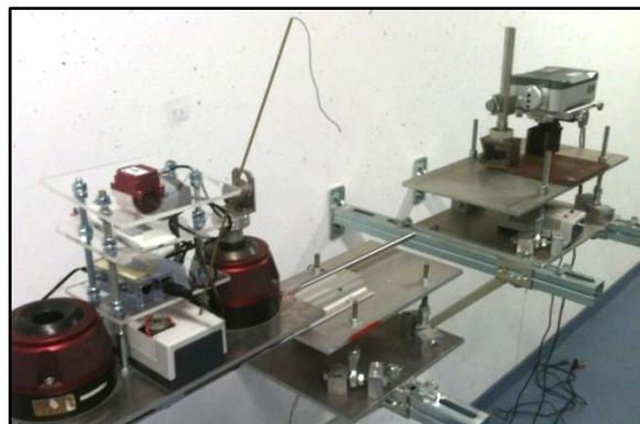
Figure 7 : Vue du dispositif mis en place pour le protocole de positionnement avec système GNSS/INS, avec le chariot mobile (à gauche) et l'émetteur-récepteur interférométrique (à droite).
