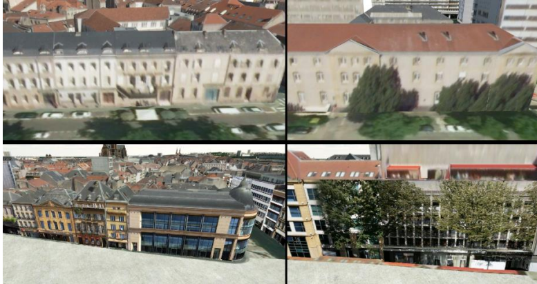
Illustration 6 : Texturation par PVA pour les images du dessus et par système terrestre en dessous
