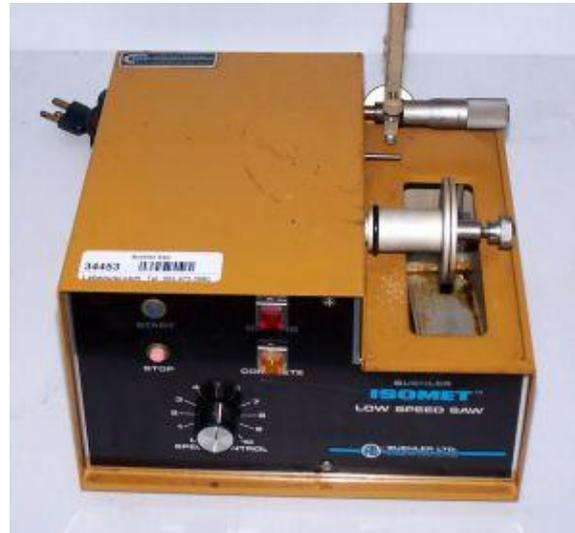
**Fig. 4 : IsoMet tronçonneuse de précision Buehler® LTD.**
