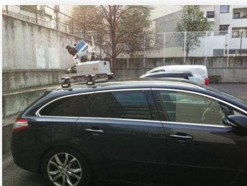
Figure 14 : Système Pegasus One embarqué sur le toit d'un véhicule
