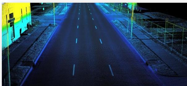
Figure 15 : Nuage de points issu d'une acquisition avec le système Pegasus One - source : site internet Leica.
