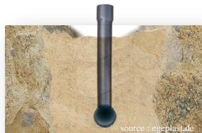
**Figure 44 : Illustration de pose des fourreaux verticaux**
