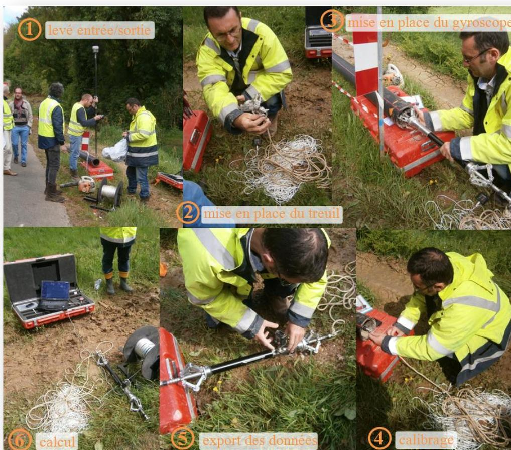
Figure 31 : Les étapes du géoréférencement par gyroscope DR-HDD-4.2 d'un forage dirigé
