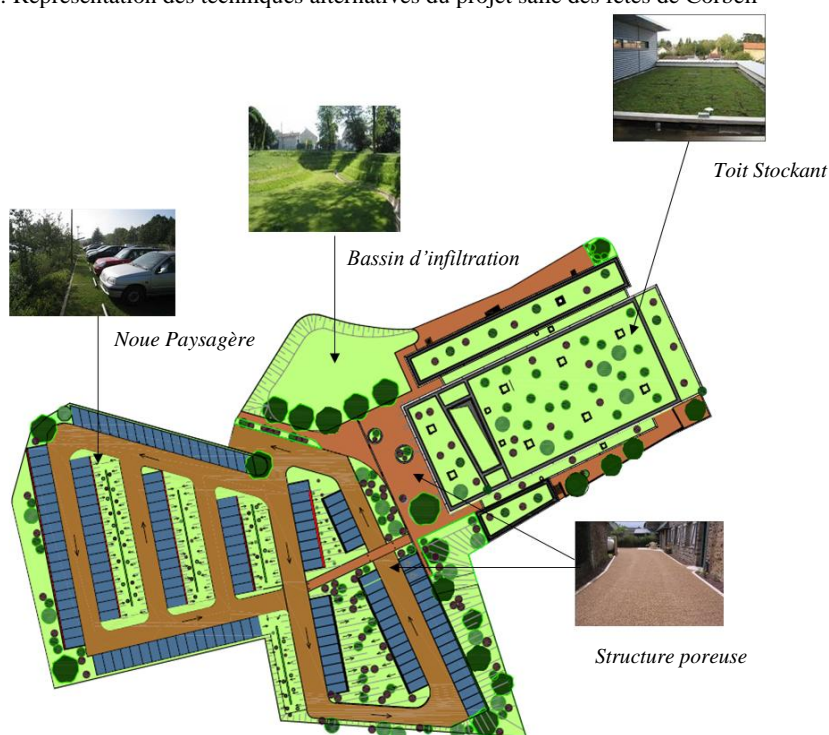
Figure 12: Représentation des techniques alternatives du projet salle des fêtes de Corbeil
