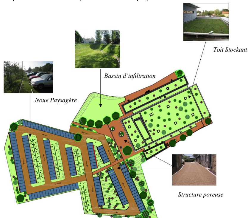
Figure 12: Représentation des techniques alternatives du projet salle des fêtes de Corbeil
