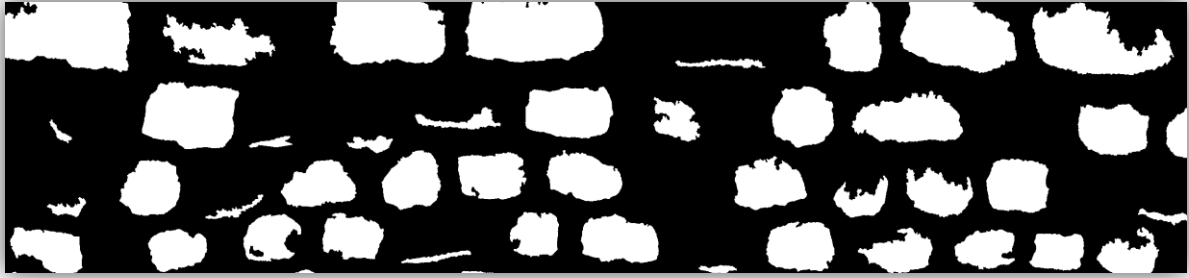
Figure 31 : Extrait d'un résultat binaire après segmentation Region based et application du Remove_small_objects
