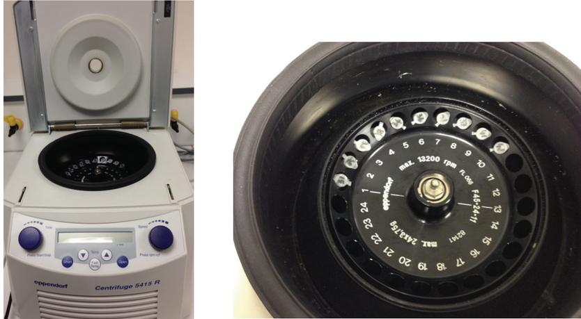
Fig 12: Tubes Eppendorf fermés, centrifugés dans une machine « Eppendorf Centrifuge 5415-R ».
