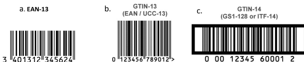
Figure 9 : a. Code EAN13. b. Code GTIN-13. c. Code GTIN-14
