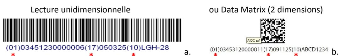
Figure 8 : a. Code GS1-128 (format code barre). b. Code GS1-128 (format data matrix).
